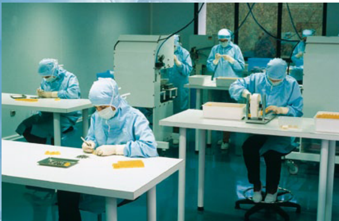
Der Produktionsstandort ist mit einem Reinraum ausgestattet, der nach der Klasse ISO 8 zertifiziert ist.
